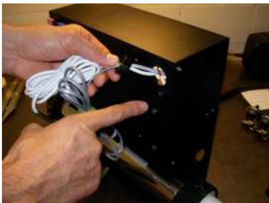
Kabel mit der Kabeldülle herausziehen
