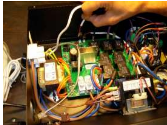
dann herausziehen, es sind 2 Stifte (beim wieder hineindrücken, mit Vorsicht drauf- stecken – gefühlvoll hantieren!!)
