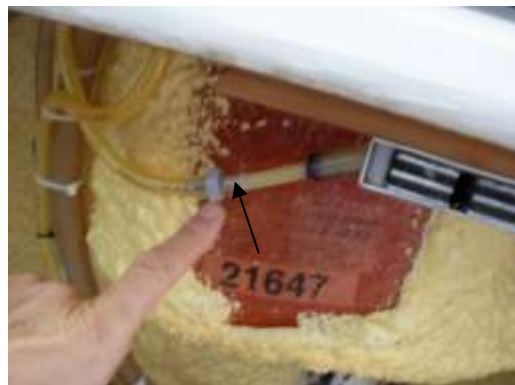
Ventil = hier abtrennen (siehe Fingerzeig) Ev. Ventil verstopft = wechseln
